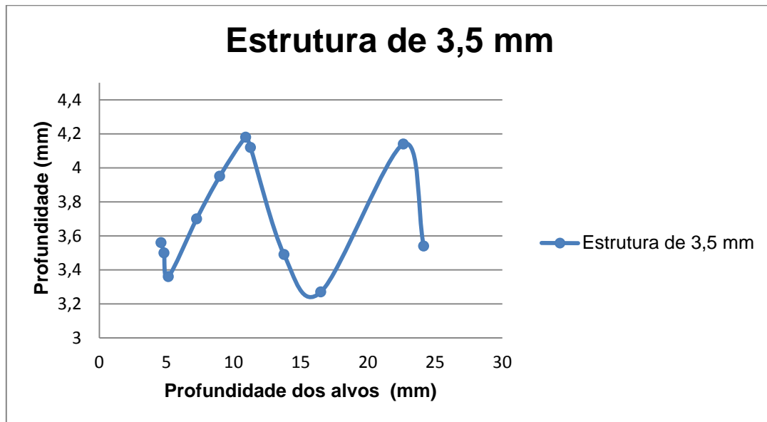
Figura 5.38 Medição de uma estrutura de 3,5 mm a diferentes profundidades.
