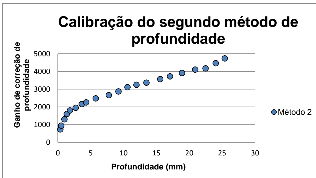
Figura 4.17 Gráfico com a relação ganho de correção de profundidade com a profundidade.
