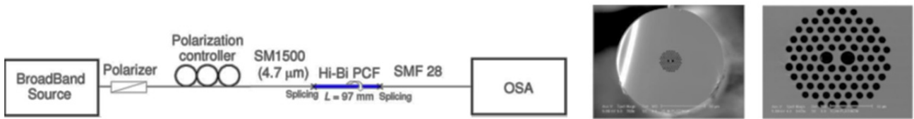
Figura 2.15 - Confirmação experimental utilizando uma Hi-Bi PCF para medição de torção e respectiva foto da fibra [31]
