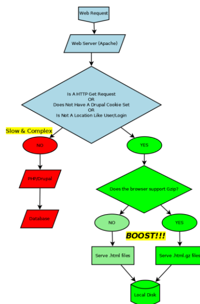
Figura 57 - Funcionamento Módulo Boost
