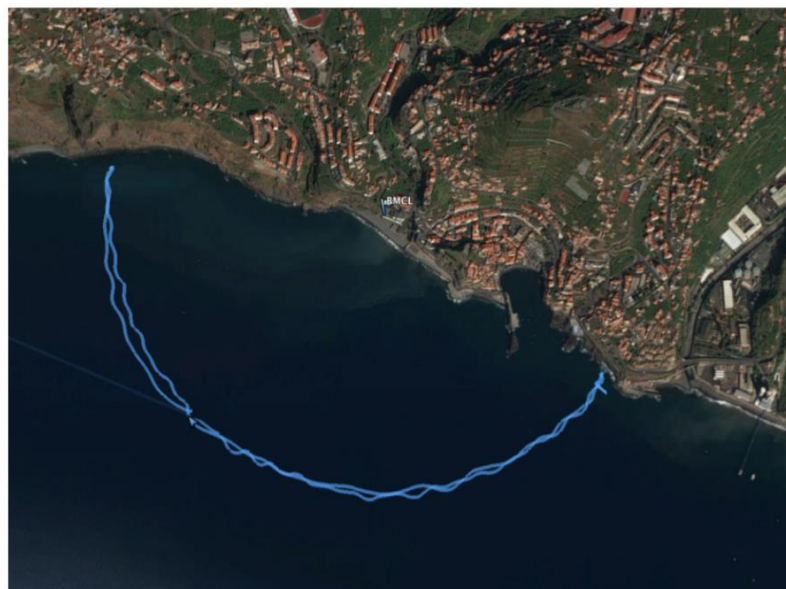
Figura 31: Percurso efetuado na medição do diagrama de radiação da antena recetora na estação BMCL.
