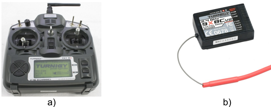
Figura 2. 28 - Componentes do telecomando: a) comando com transmissor rádio; b) recetor rádio.
