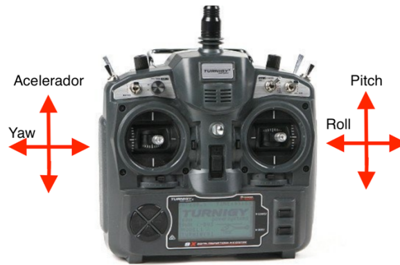
Figura 2. 29 - Configuração dos manípulos e respetivas variáveis controláveis.
