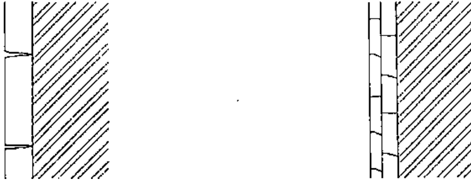
Figura 2: Reboco numa só camada (à esquerda) e reboco com várias camadas (à direita) (adaptado de Veiga M. R., 1998)
