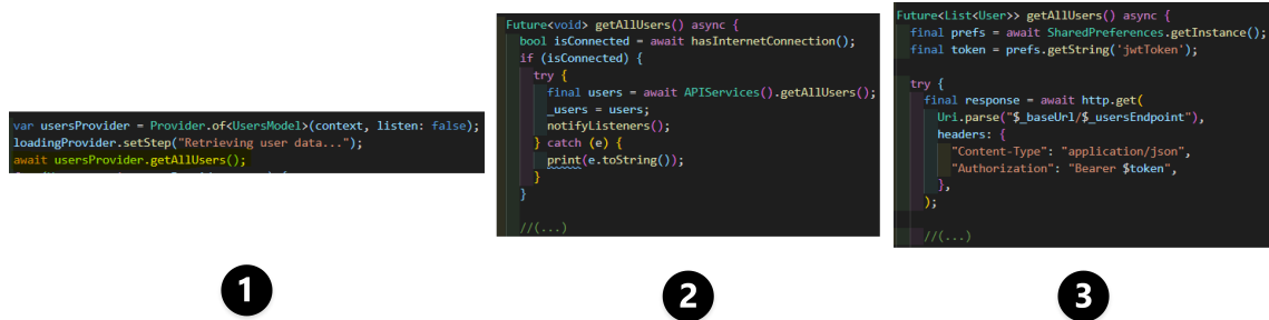
Figura 35. Implementação do MVVM: A Vista (1) solicita os dados dos utilizadores ao Modelo de Vista (método getAllUsers ). O Modelo de Vista (2) solicita os dados ao Modelo, através da chamada ao serviço correspondente (3) e notifica a Vista sobre as alterações nos dados, através do método notifyListeners
