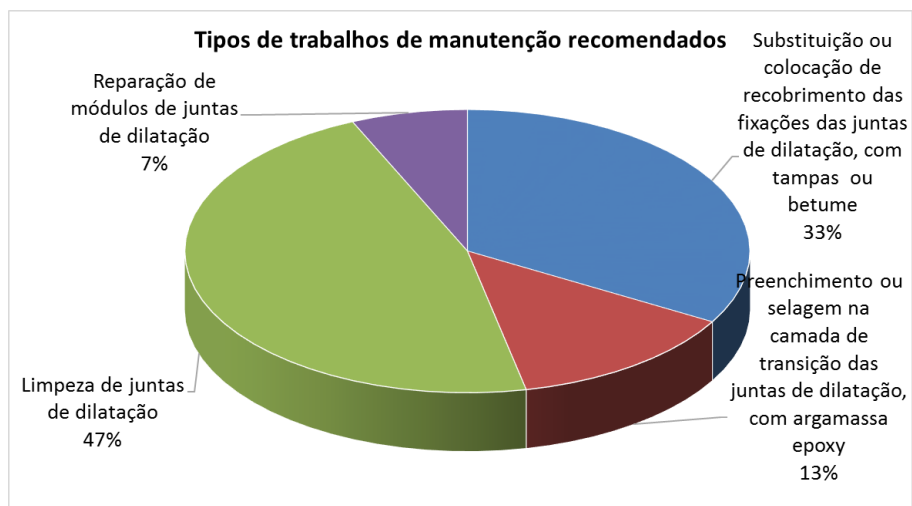
Figura 5-10 Tipos de trabalhos de manutenção em juntas de dilatação e a sua distribuição relativa
