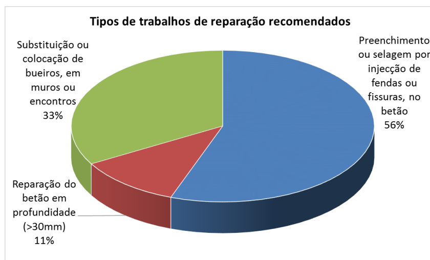
Figura 5-8 Tipo de trabalhos de reparação nos encontros e a sua distribuição relativa
