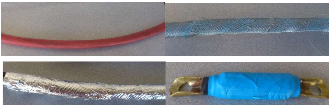
Figura 5.24 – Cabo e colocação da bainha.
