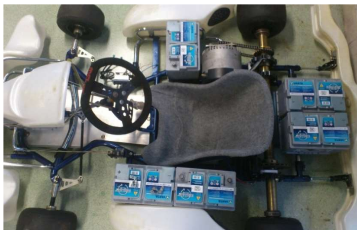
Figura 5.20 – Disposição das baterias no veículo elétrico.
