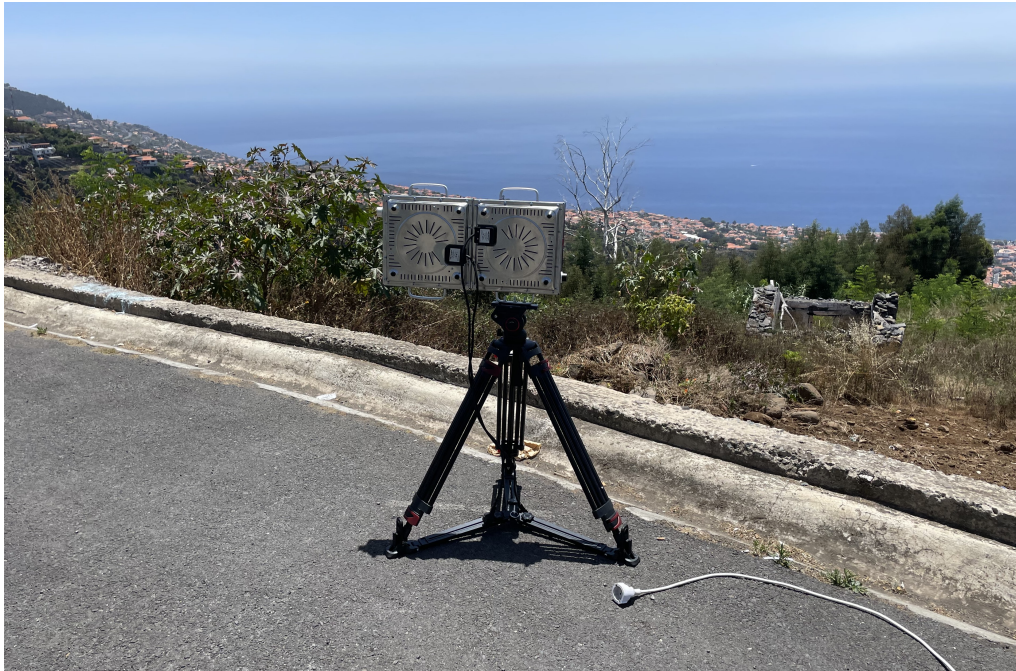
Figura 56. Placa de vitrocerâmica que simula um foco de incêndio
