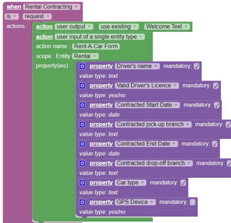
Figura 65. Regra de Ação para o pedido ( request ) de uma transação “Rental Contracting”
