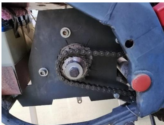
Figura 5-34 - Suporte para utilizar o motor PMDC na moto.
