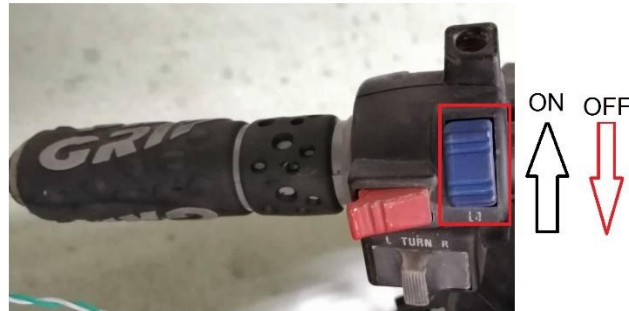
Figura 5-32 - Interruptor utilizado para ligar a bateria auxiliar de +12V ao driver e ao microcontrolador.
