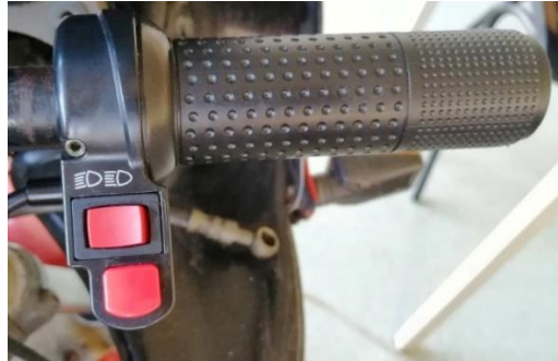
Figura 5-7 – Acelerador elétrico com sensor de efeito de Hall.
