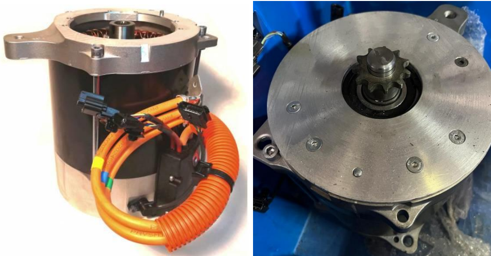
Figura 6.2: Máquina assíncrona da MAHLE utilizada nos veículos Renault Twizy (esquerda) [42] e adaptação realizada ao motor (direita).
