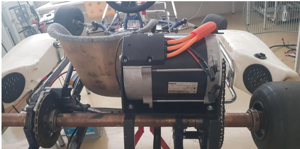
Figura 6.3: Motor utilizado e montado no carro para a realização de testes práticos.
