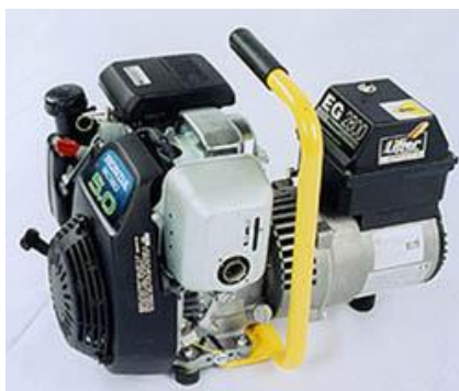
Figura 3.4 – Gerador utilizado com o motor Honda GC160
