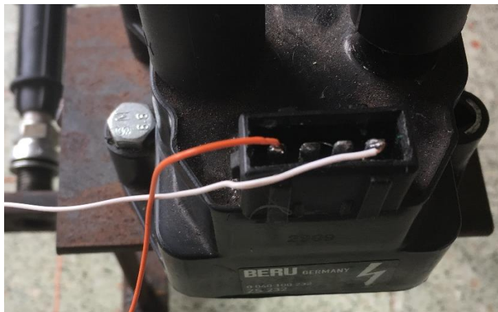
Figura 4.8 – Ligação da bobine ao circuito. Fio laranja (12 V) e o fio branco estava ligado ao dreno do transistor
