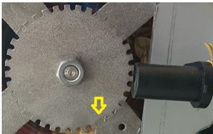
Figura 2.20 – Roda dentada, assinalando a falha do dente e o sensor de Hall
