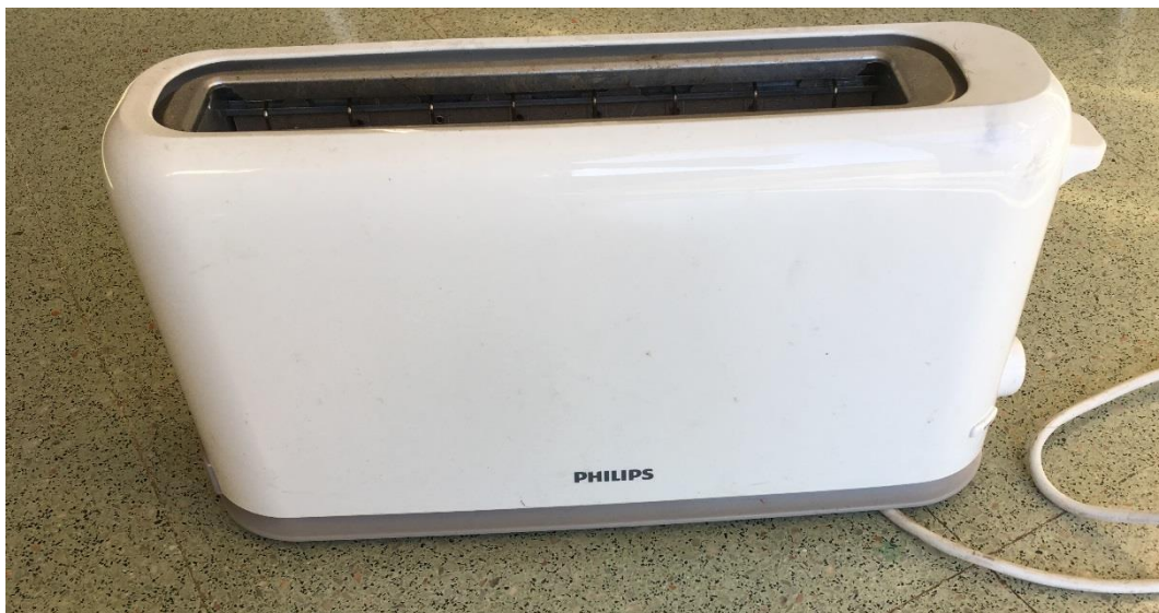
Figura 4.17 – Torradeira utilizada como carga (1150W)
