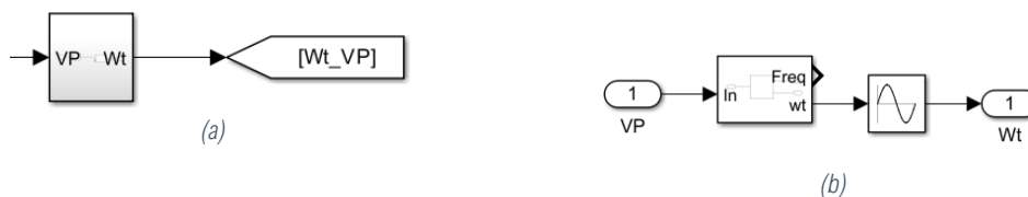
Figura 6.6 Bloco de sincronização: (a) PLL; (b) Esquema interno do PLL.
