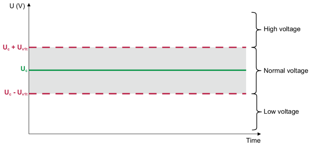
Figura F.8 Valor da tensão de referência com a banda morta inferior e superior [20].
