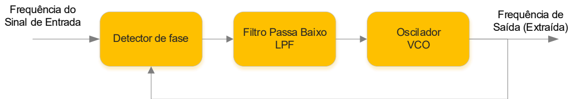
Figura 2.26 Esquema genérico de um PLL [38].
