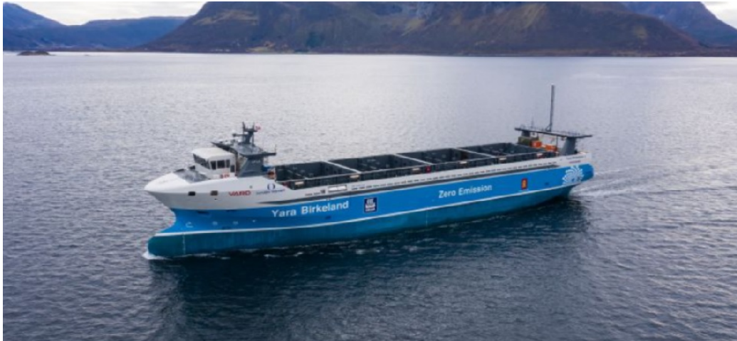
Figura 2.8: Navio porta-contentores Yara Birkeland , o navio de propulsão elétrica preparado para uma navegação autónoma (Fonte: www.offshore-energy.biz/worlds-1st-zero-emission-container-vessel-yara-birkeland-delivered ).
