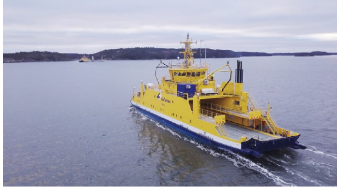
Figura 2.3: Navio ferry Falco , o primeiro navio de teste não tripulado (Fonte: www.theengineer.co.uk/falco-autonomous-ferry-rolls-royce ).
