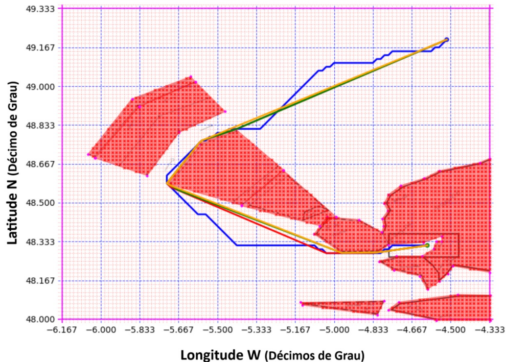
Figura 4.8: Esquema de separação de tráfego exterior norte, com saída do porto: Derrotas obtidas pelo método proposto.
