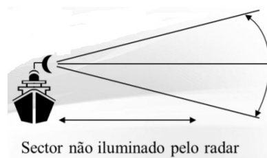
Figura 2.14: Limitação do Radar para objetos a pequena distância (Fonte: [30]).
