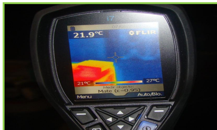
Figura 9: Câmara térmica de infravermelhos (foto do autor 2012)
