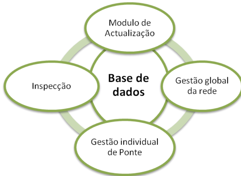
Figura 40: Organização geral do sistema – ligações entre elementos
