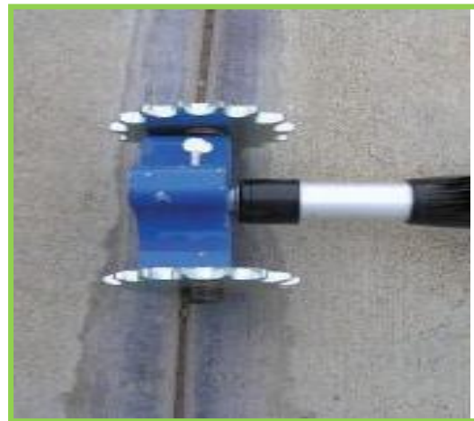
Figura 46: Aparelho rotativo de percussão para identificação de anomalias no betão [11]
