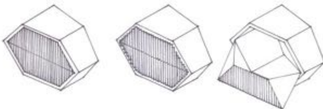
Figura 97: Estudo da janela retrátil nas diferentes posições.
