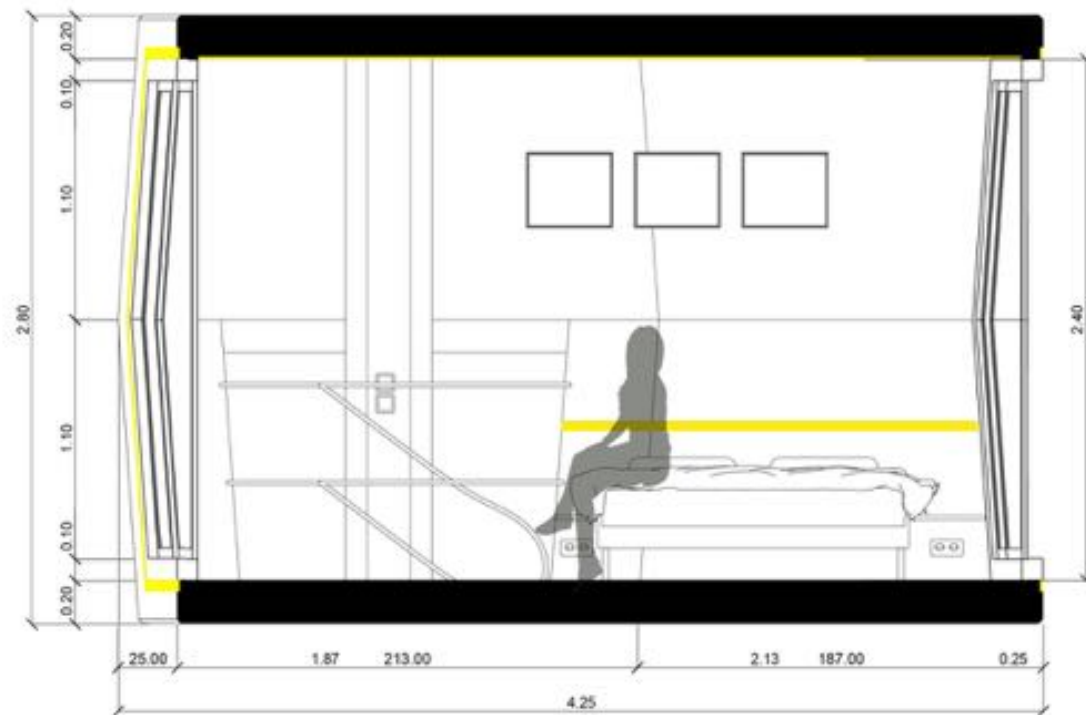
Figura 133: Corte Longitudinal L-L' Módulo n.º 3.
