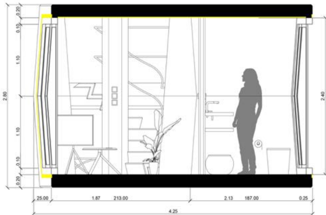
Figura 143: Corte Longitudinal T-T' Módulo n.º 5.
