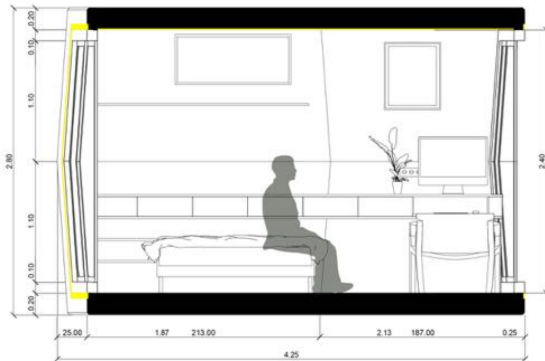
Figura 132: Corte Longitudinal K-K' Módulo n.º 3.
