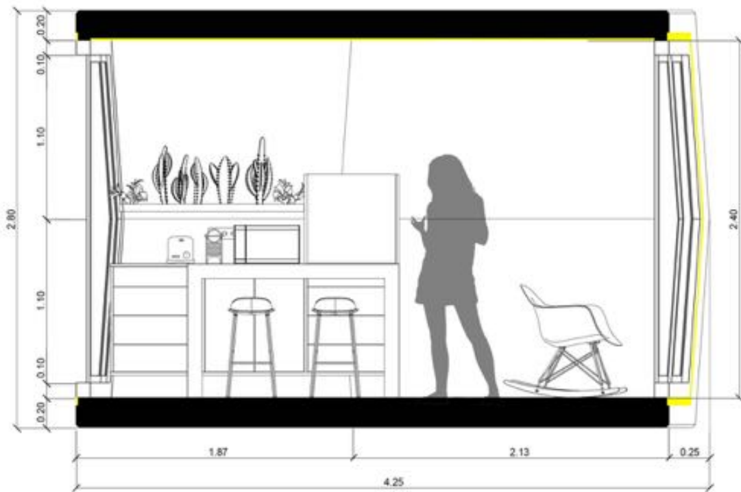
Figura 122: Corte Longitudinal C-C' Módulo n.º 1.
