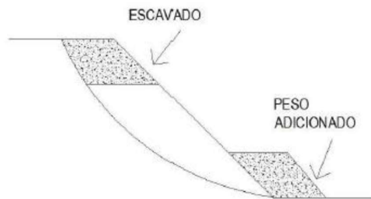
Figura 53 - Escavação de material na crista do talude [103].
