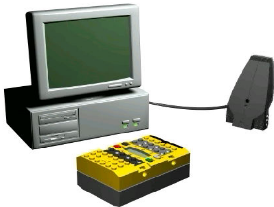
Figura 23 - Comunicação entre o computador e o RCX
