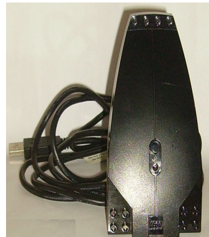
Figura 24 – Torre de Infravermelhos
