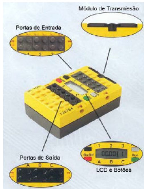
Figura 19 - O RCX da Lego MindStorms
