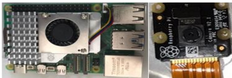
Figura 30- a) Raspberry Pi 5 com dissipador e ventoinha. b) Módulo da câmera NoIR.
