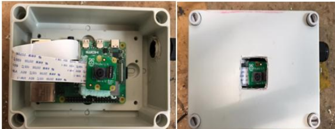
Figura 45- Raspberry Pi instalado dentro do protótipo.
