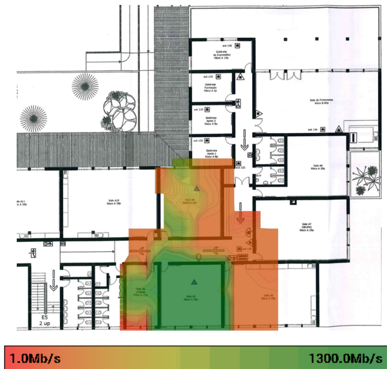
Figura 50 - Heatmap do Data Rate no piso 1 bloco A2
