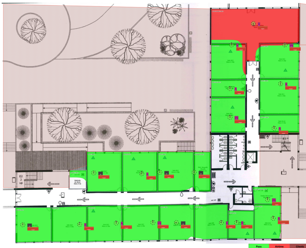
Figura 95 - Heatmap relativo ao Capacity Health no bloco B piso 2
