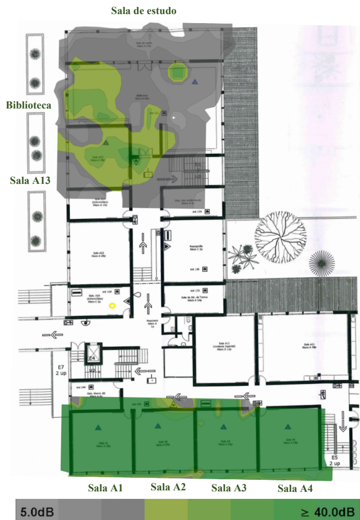
Figura 25 – Heatmap do SNR no bloco A1 piso 1
