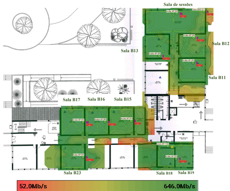
Figura 38 - Heatmap relativo ao Throughput no piso 1 Bloco B
