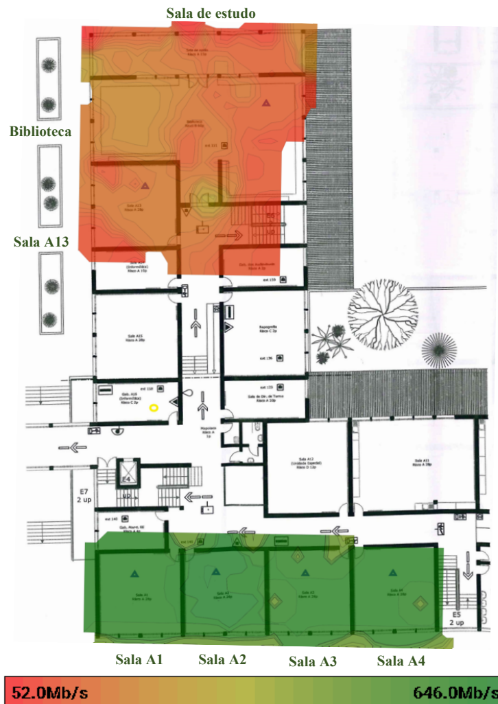
Figura 24 – Heatmap do Throughput no piso 1 bloco A1
