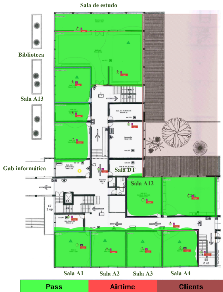
Figura 34 – Heatmap do Capacity Health no piso 1 bloco A1
