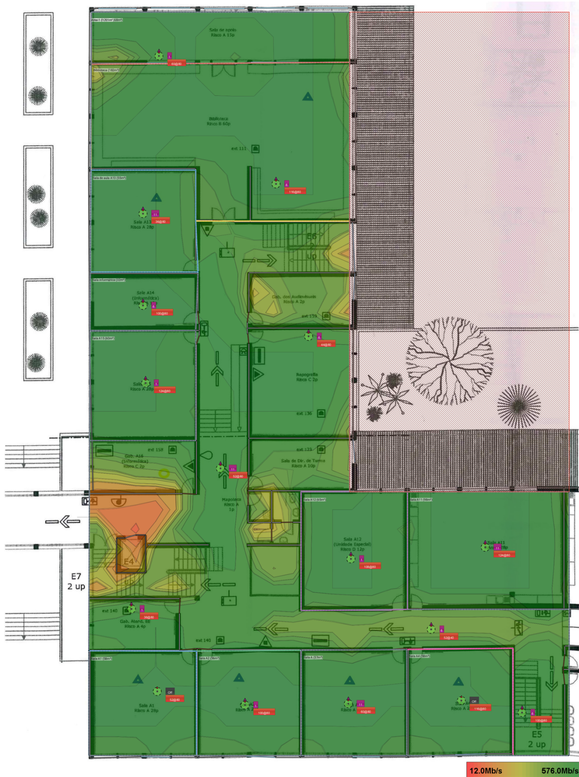
Figura 73 - Heatmap relativo ao Throughput no piso 1 bloco A1
