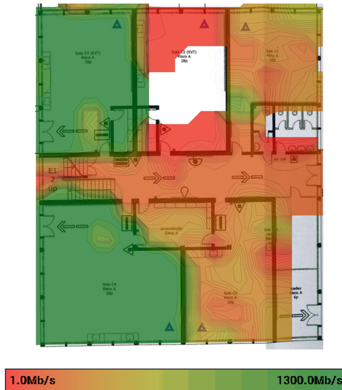
Figura 68 - Heatmap do Data Rate no piso 0 do bloco C
