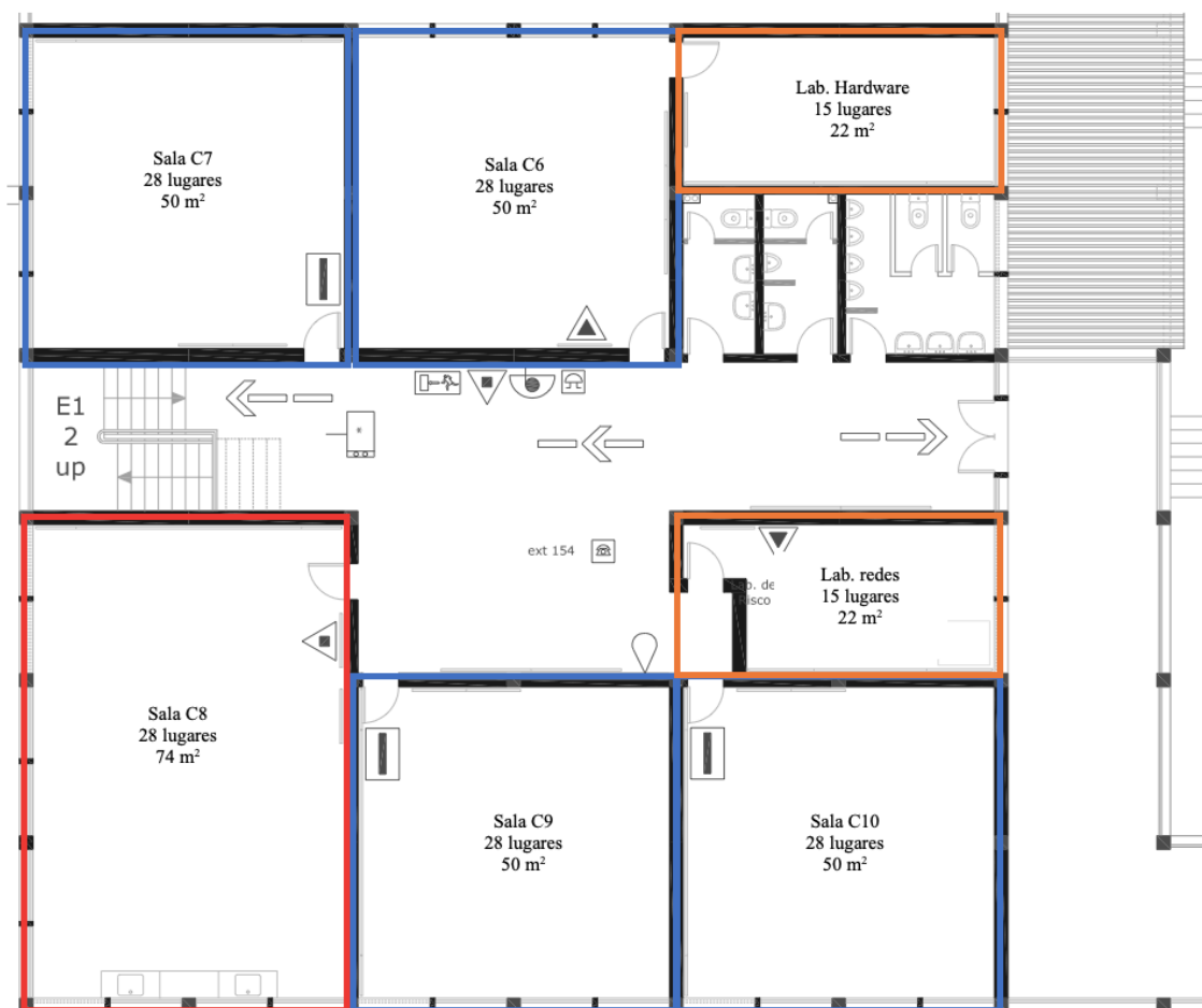
Figura 46 - Descrição e caracterização dos espaços no piso 1 do Bloco C
