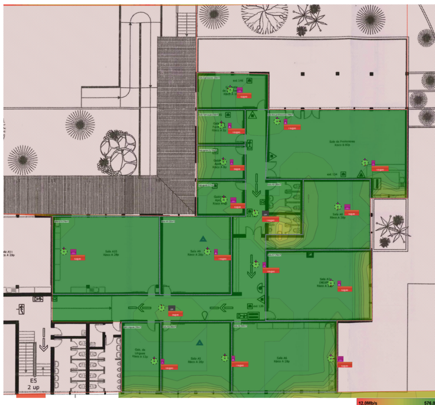
Figura 79 - Heatmap relativo ao Throughput no piso 1 bloco A2
