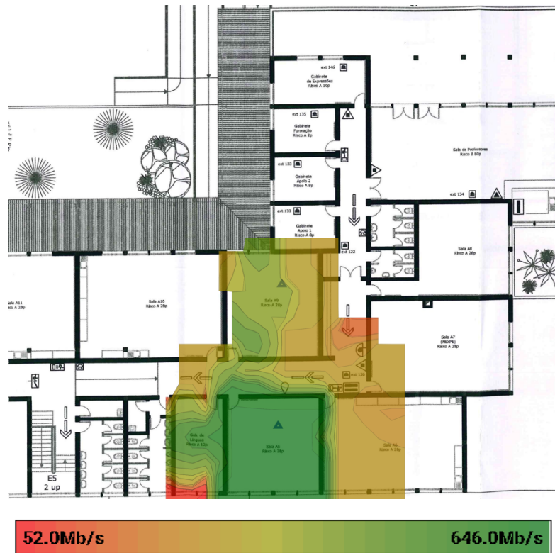
Figura 51 - Heatmap do Throughput no piso 1 bloco A2
