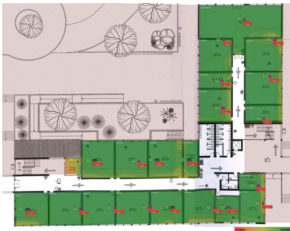
Figura 91 - Heatmap relativo ao Throughput no piso 2 bloco B
