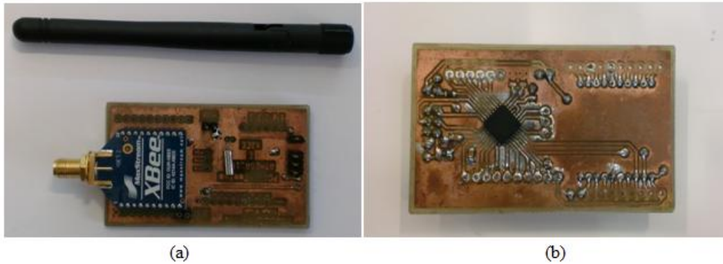
Figura 4.7- Módulo de controlo e comunicação de dados. (a) Face superior da placa; (b) Face inferior.
