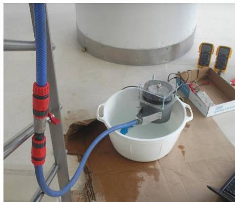
Figura 3.25 – Esquema de montagem para obtenção das curvas características do sistema hídrico.
