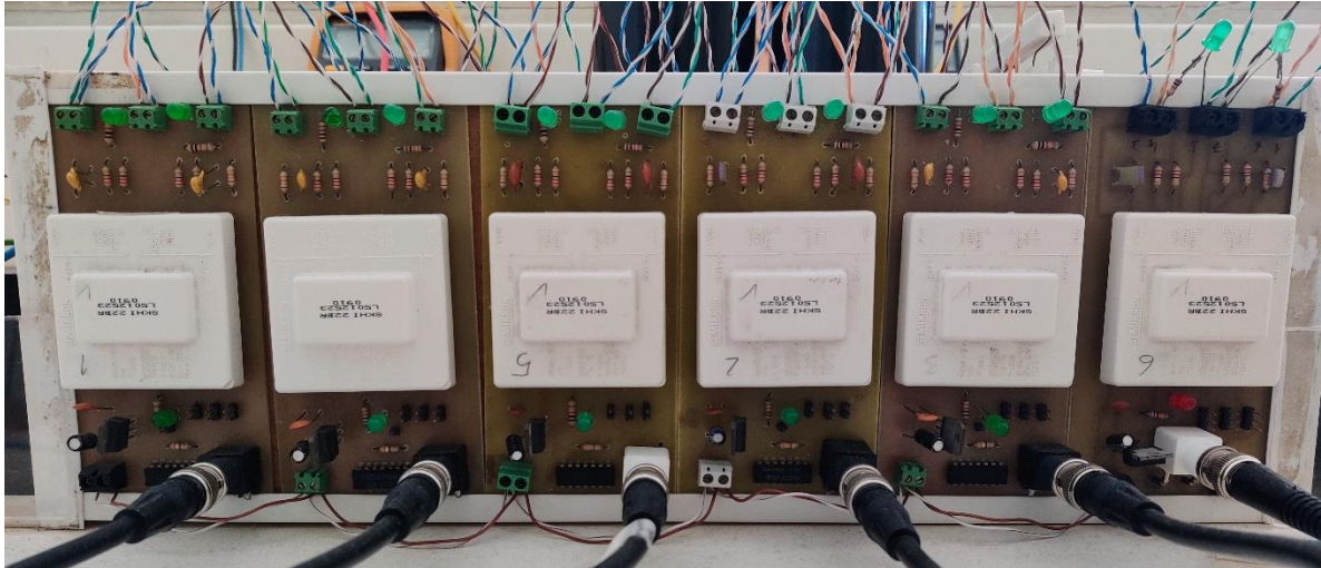
Figura E.3 – Drivers utilizados para o controlados dos IGBT do protótipo laboratorial do conversor NPC.
