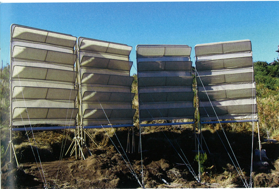
Figura 7 – Estação de captura de água atmosférica instalado na Bica da Cana, no âmbito do Projecto Dysdera.
