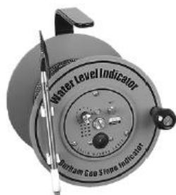
Figura 2.14 – Piezómetro (Durham Geo-Enterprises, Inc, 2012)
