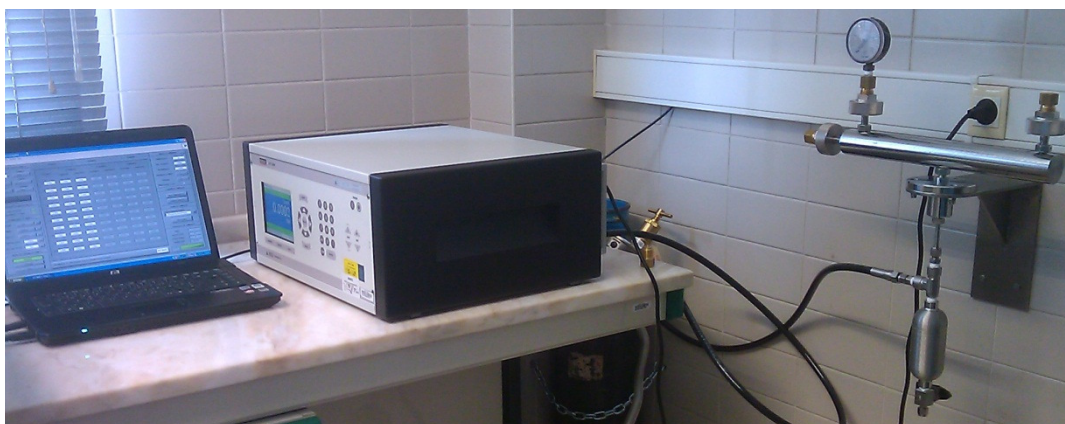
Figura 6.18. Configuração dos equipamentos para calibração de um manómetro analógico
