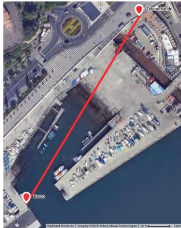
Figura 6.22 – Representação geográfica da localização do telecomando e do barco autónomo com comunicação em linha de vista.
