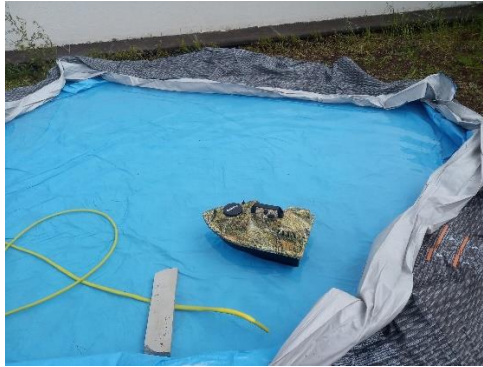
Figura 6.14 – Piscina montada para realizar os testes de controlo de direção.
