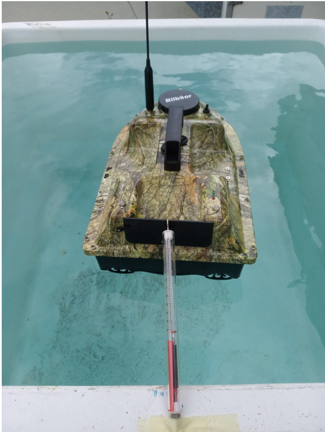
Figura B.4 – Teste da força equivalente em modo comum gerada pelo motor direito.
