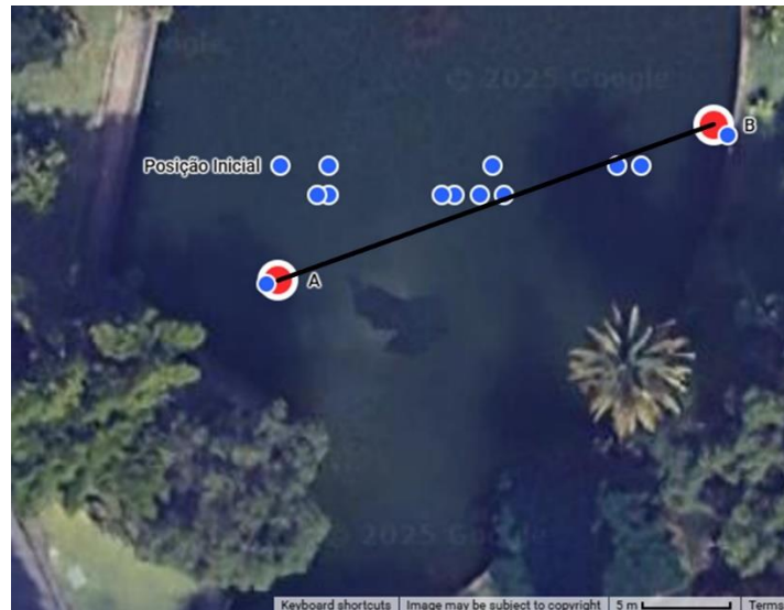
Figura 6.19 – Definição e trajeto de um percurso novo do barco autônomo pela transmissão do comando de nova trajetória com dois pontos de referência.
