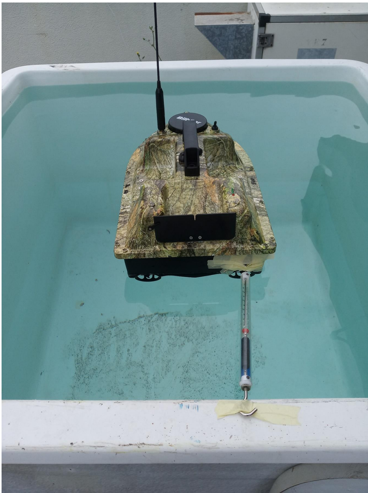
Figura B.3 – Teste da força equivalente gerada pelo motor.
