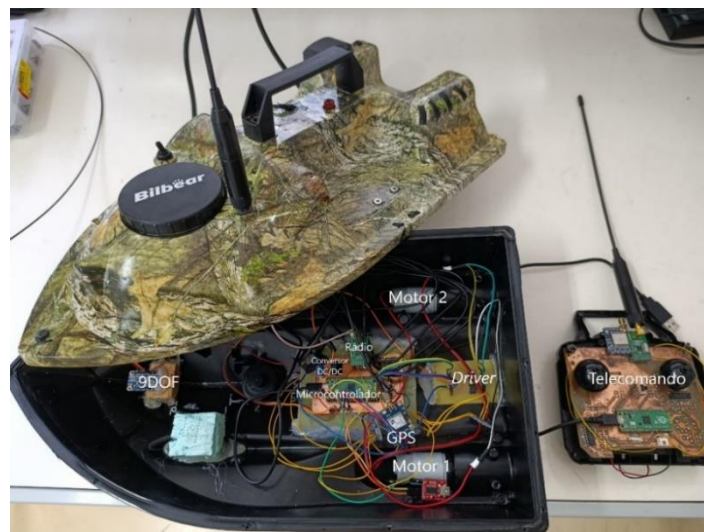
Figura 6.9 – Circuitos do barco autónomo e telecomando.
