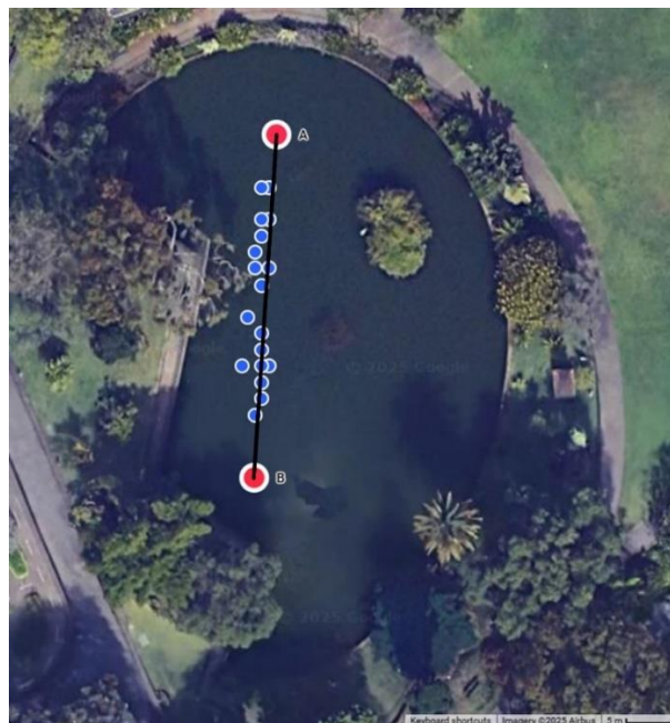
Figura 6.18 – Definição e trajeto de um percurso do barco autónomo entre dois pontos de referência.
