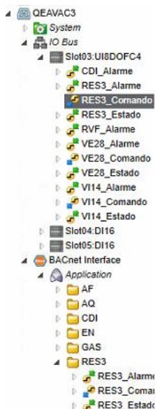
Figura 77. Importação de pontos BACnet num quadro de automação.
