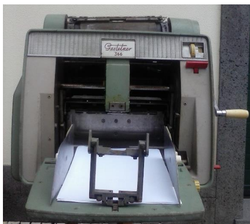
Fotografia 14 – Duplicador Gestetner, mod. 366 c/ n.º 2-C-4139, utilizado pelo Centro de Informação, na impressão de comunicados e panfletos, para o esclarecimento das massas populares. (Foto João Bernardo Martins, 2015)
