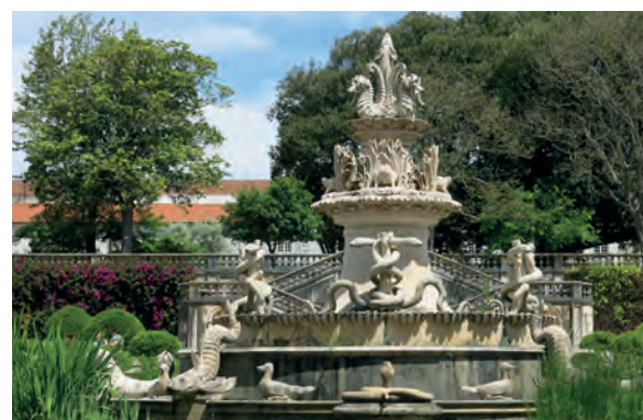
Fig. 3.24 – A Fonte das 40 Bicas antes da limpeza de que foi alvo em 2017 tinha uma coleção de plantas aquáticas nos seus muitos canteiros. No entanto, verificou-se que sendo a fonte constituída por módulos que encaixam uns nos outros, muitas dessas plantas metiam-se entre as ligações de pedra obrigando à sua abertura. Hoje, para salvaguarda deste património único, optou-se por não fazer plantações diretas, usando-se vasos colocados no fundo da fonte onde se plantaram nenúfares.
