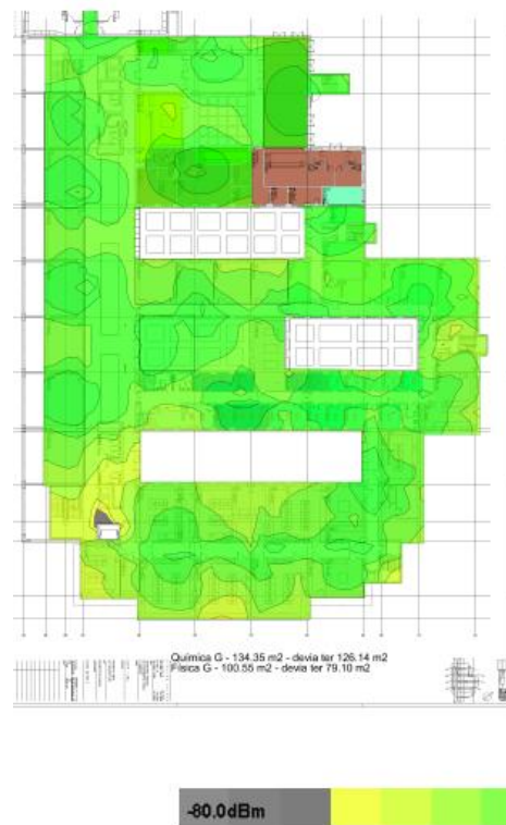
Figura D.16- Potência de sinal do piso 0, na proposta híbrida
