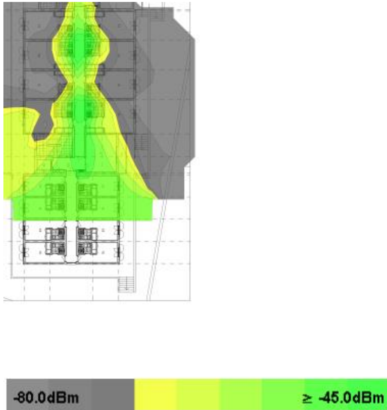
Figura H.14- Potência de sinal da antiga rede da residência, piso 3 (zona sul)
