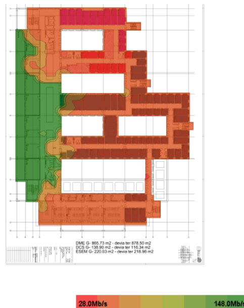
Figura 6.28- Data Rate com APs 802.11n, do piso 2
