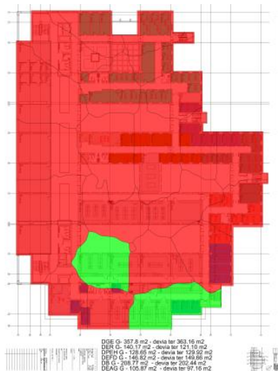
Figura D.25- Problemas da rede no piso 1, na proposta híbrida
