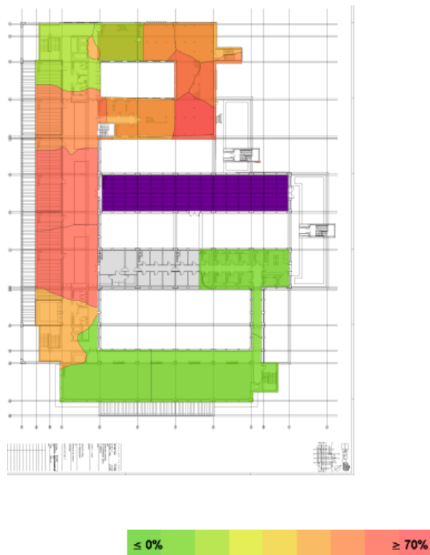
Figura C.35- Percentagem de utilização dos APs, no piso 3 da Penteada
