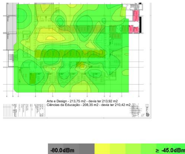
Figura 6.3- Potência de sinal, com a antena ao nível da porta USB
