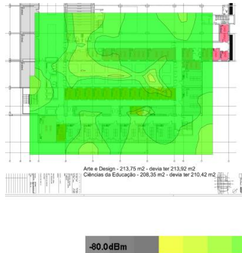
Figura 6.2- Potência de sinal, com a antena ao nível do monitor
