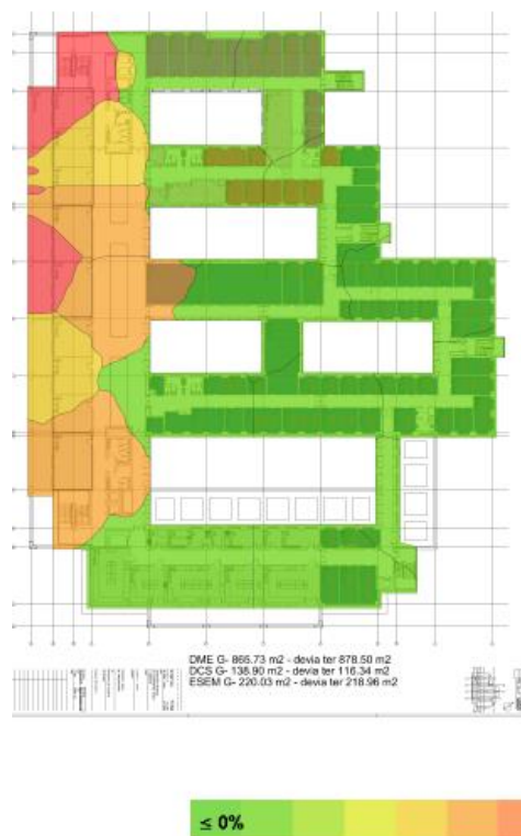
Figura C.29- Percentagem de utilização dos APs, no piso 2 da Penteada
