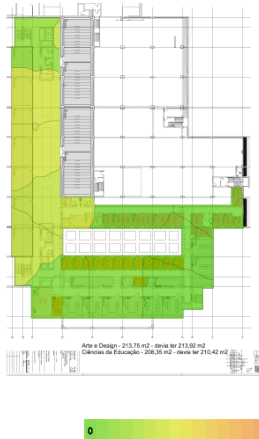
Figura C.12- Distribuição do nº de clientes por AP no piso -1, da Penteada
