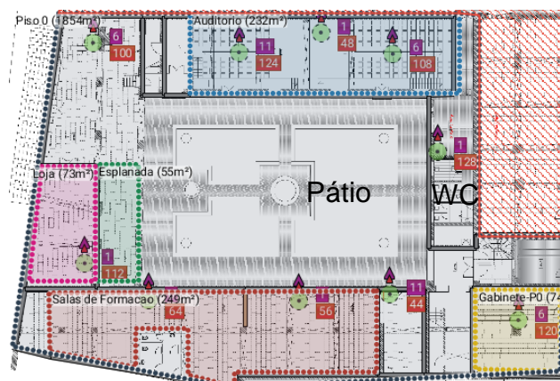
Figura 5.16- Distribuição dos APs, no piso 0 da Reitoria
