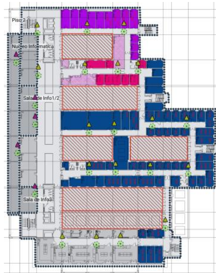
Figura 5.10- Distribuição dos APs de norma 802.11n, no piso 2
