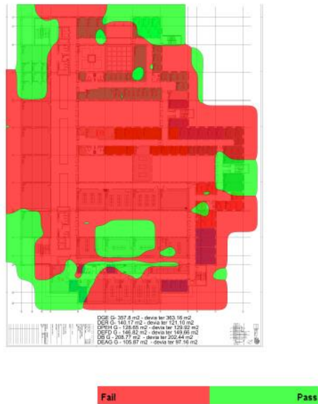
Figura B.22- Estado da rede do piso 1, da Penteada
