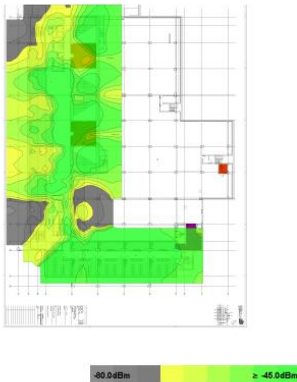
Figura B.2- Potência de sinal do piso -2, da Penteada
