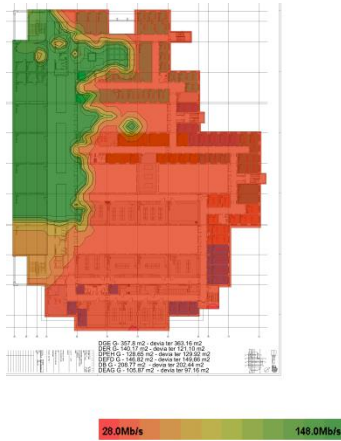
Figura D.23- Throughput do piso 1, na proposta híbrida
