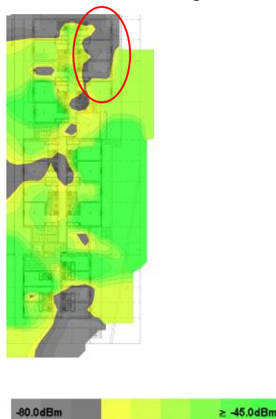
Figura 6.41- Potência de sinal do piso 1 após a nova rede
