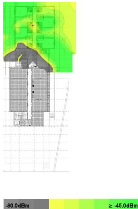
Figura I.2- Potência de sinal da nova rede da residência, piso 0
