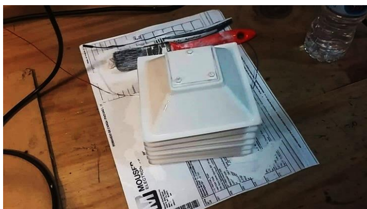
Figura 7.25 Estrutura anti-rradiação para o sensor de CO Figaro TGS 5042.
