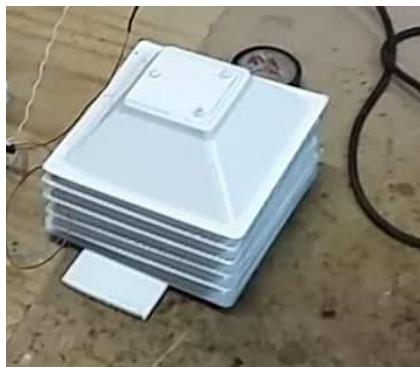
Figura 4.12 Estrutura antirradiação para o sensor Figaro.
