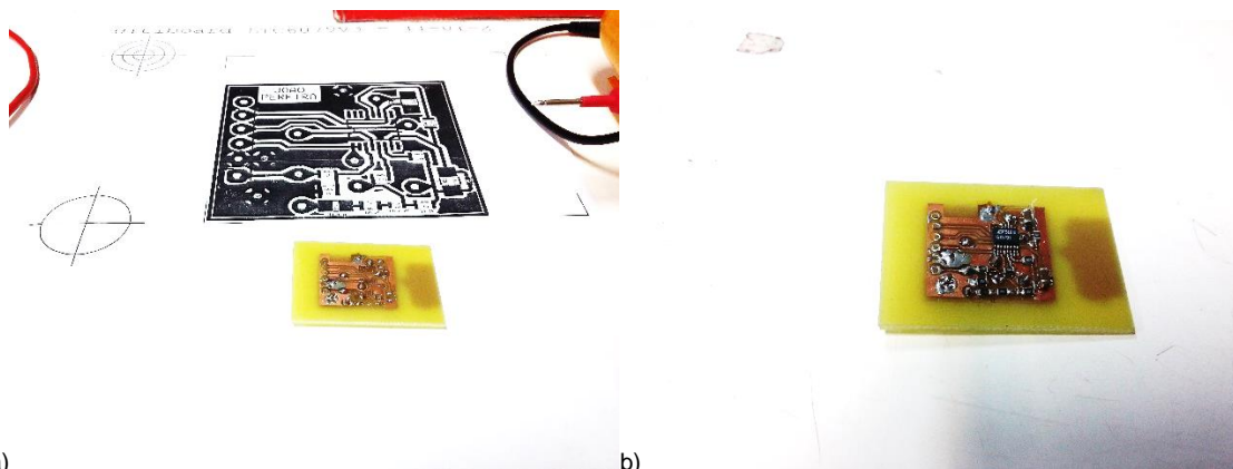
Figura 7.24 Placa de circuito impresso – circuito de condicionamento sensor de CO.
