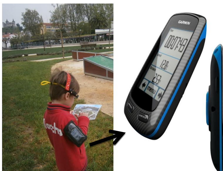
Figura 3.2: GPS da marca GARMIN , modelo Edge® 800 , usado na recolha de dados
