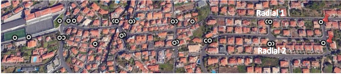
Figura 4.12 - Pontos com antenas no solo.
