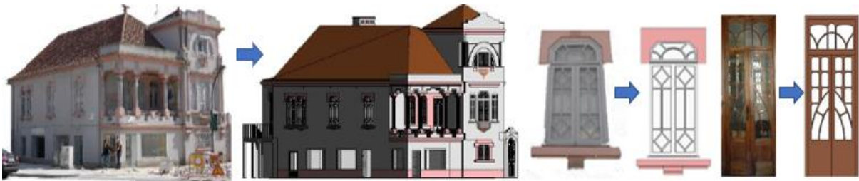
Figura 34 - Modelação em 3D da Casa Santo António e objetos que a constituem (adaptado de [68]).
