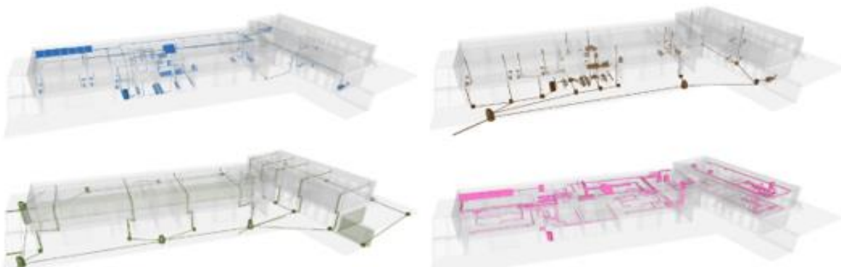
Figura 57 - De cima para baixo temos os Modelos de Rede de Águas Prediais, Rede de Águas Residuais Domésticas, Rede de Águas Pluviais, Modelo AVAC (adaptado de [77]).
