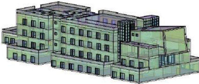
Figura 41 - Modelo Energético do Edifício.
