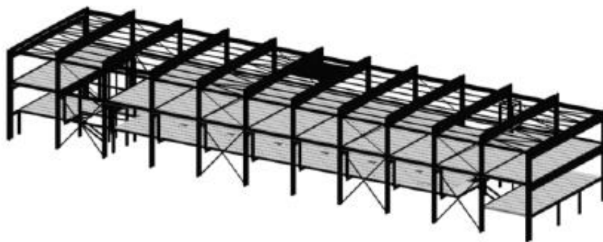
Figura 44 - Estrutura metálica do edifício [72].
