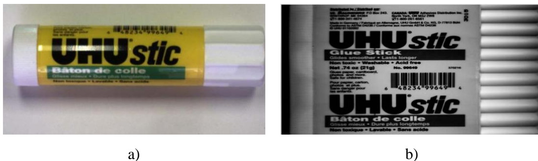
Figura 2-18 – Imagens capturadas com 2 diferentes tipos de sensor. a) sensor de área e b) sensor de linha [33].
