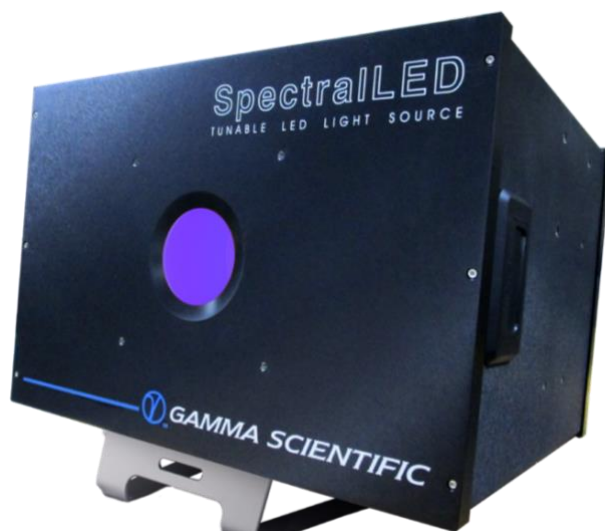
Figura 5-34 – Fonte de luz utilizada para a análise das diferentes QE.
