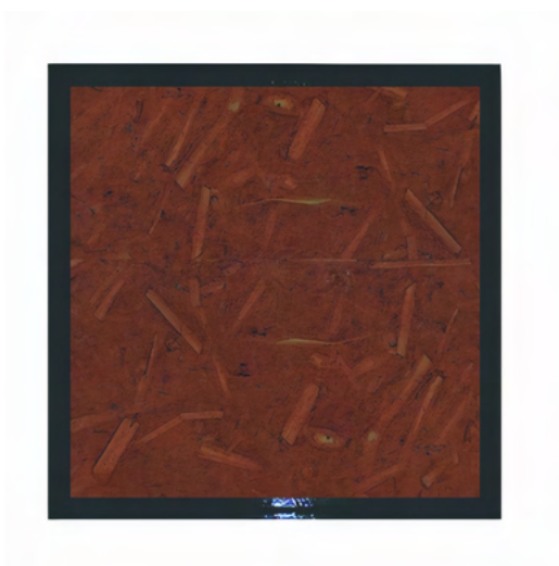
Figura 71: Solução escolhida para o exterior constituída por argila, palha e água. (Joseph Caires). (2022).
