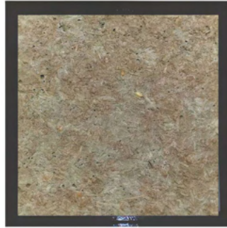
Figura 69: Ligante cimento + terra + palha + água.
